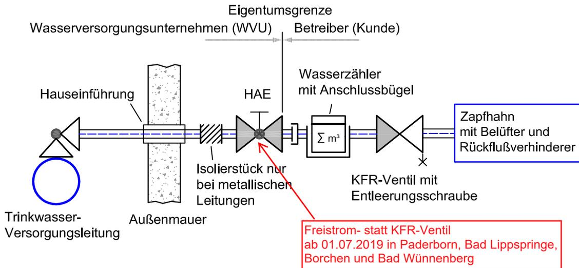
Aufbau des Wasserhausanschlusses bei der Inbetriebnahme der Gebäudeinstallation
